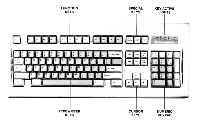
FIGURE D-1. THE COMMODORE PC40-III KEYBOARD THE COMMODORE PC40-III KEYBOARD
